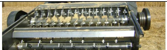
Çizelge 2. Biçerdöver monte edilen sap parçalayıcı ve parçalayıcıya ait teknik özellikler
